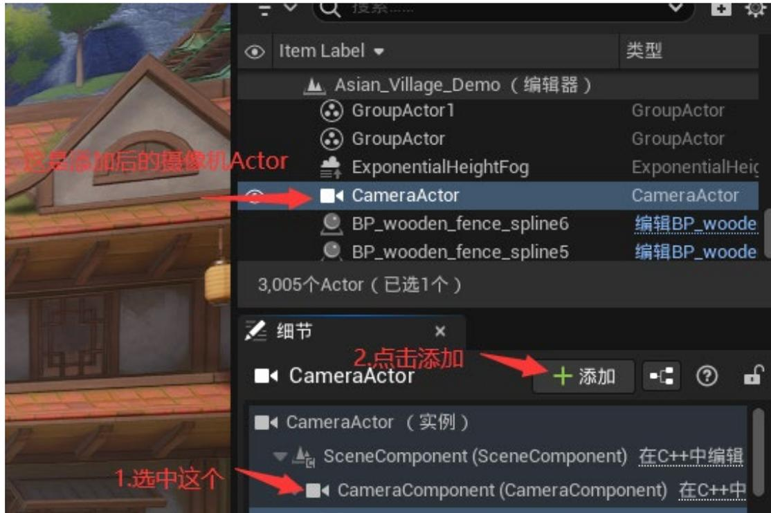
点击添加后在搜索框里输入 XR，点击筛选出来的插件添加，前景相机和背景相机都应该要放置在相机的 cameraComponent 下，如下图所示：
