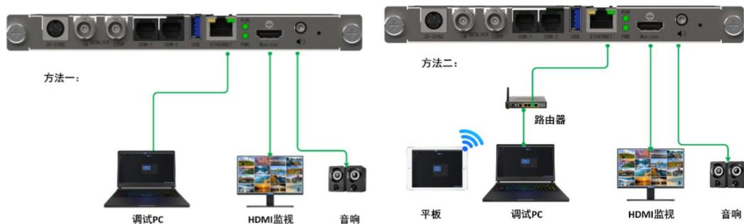
方法二：ETHERNET 接口通过标准网线连接到路由器，调试控制 PC 通过标准网连接到路由器中，此时 Pad 等移动端也可接入路由器 WiFi 实现无线控制；
