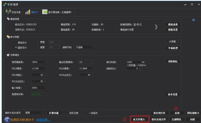
若目前无匹配的箱体文件，则需要进行智能设置操作，具体可参考“控制系统使用说明”进行对应设置操作
