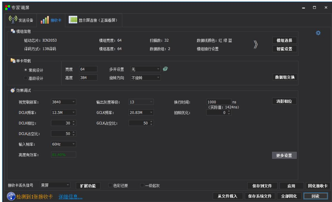
切换到显示屏连接，串完连接图在应用，显示正常固屏连接，最后在全部固话完成之后将屏幕和终端设备断电重启，查看屏幕要显示和断电重启之前显示一致。
