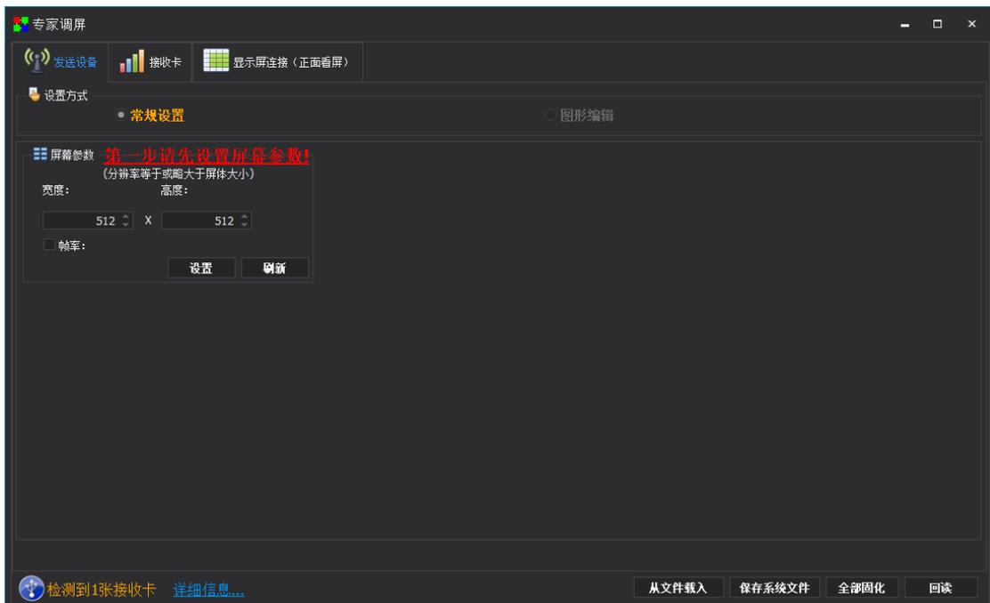
切换到接收卡调试，配置模组好参数在应用，显示正常固话接收卡。
